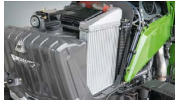
Die Kühlanlage verfügt über große Ansaugflächen mit optimaler Luftzufuhr. Vorteil: geringe Verschmutzung bei extremen Bedingungen. Der Getriebeölkühler kühlt über Wärmetauscher das Hydrauliköl mit.
