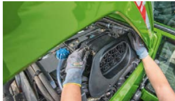
Der Luftfilter mit Zyklon-Vorabscheider steht für Höchstleistung bei Luftdurchsatz und Filterstandzeit. Er ist kompakt, leicht und besonders abgedichtet. Vorteil: geringer Wartungsaufwand.
