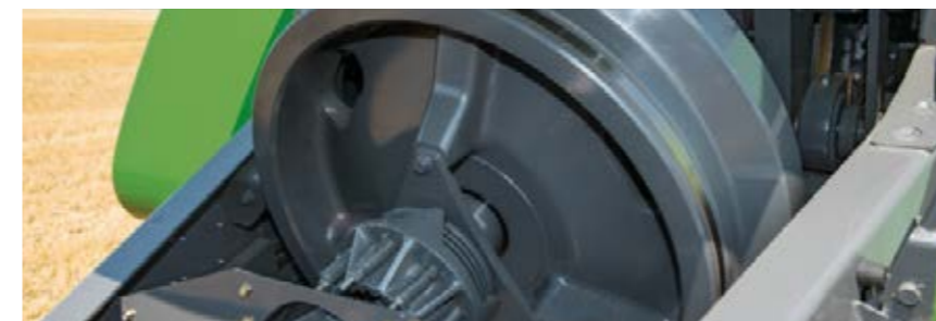
Das 545 kg schwere Schwungrad bietet einen gleichmäßigen und ruhigen Lauf der Presse bei gleichzeitig hoher Kraftübertragung.
