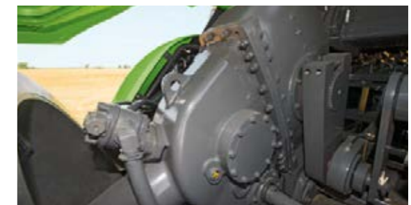
Ein neues Hochleistungsgetriebe kommt in der XD-Pressen zum Einsatz. Insgesamt ist das XD-Getriebe 35% schwerer als beim Standardmodell und kann damit noch mehr Pressdruck erzeugen.
