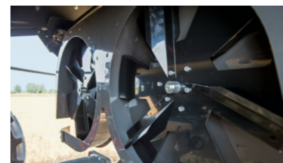
Doppeltes Extra: der mehrfach verstellbare Spreuverteiler mit Doppelrotor (optional).
