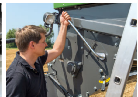
Durch Umlegen eines Hebels können Sie schnell und einfach zwischen Schwadablage und Häckseln wählen.
