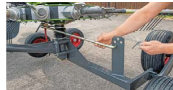
Ob langes und schweres, oder kurzes und leichtes Futter: Die Kurvenbahn passen Sie einfach an die Erntebedingungen an.
