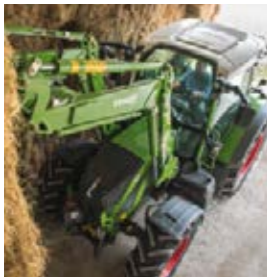
Perfekte Sicht bietet die Panorama-Frontscheibe mit durchgehenden 77 Grad Sichtfeld nach oben und auf die Radeinläufe.
