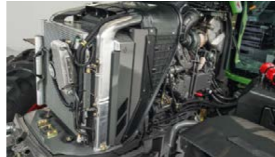
Weniger Aufwand, mehr vom Feierabend: Das kompakte Kühlerpaket ist sehr gut zugänglich und lässt sich dank der großen Abstände zwischen den Kühlern und dem ebenen Kühlerboden einfach und schnell reinigen.
