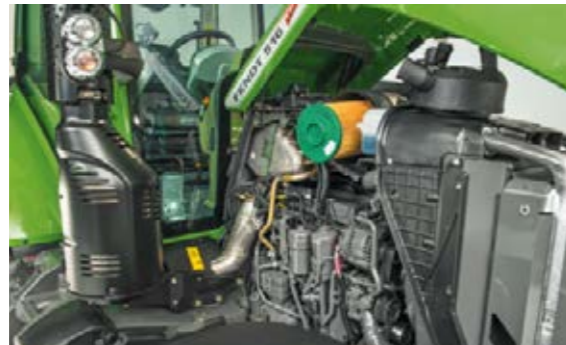
Der Hochleistungsluftfilter erreicht eine optimale Luftansaugung und -reinigung und ist einfach auszuwechseln.
