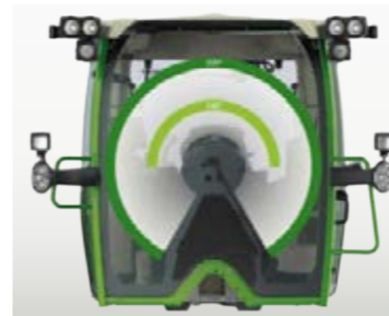
Perfekter Durchblick mit 300 Grad Wischfeld: Der exklusive Front-Scheibenwischer erfasst das gesamte Sichtfeld bis hin zu den Radeinläufen.
