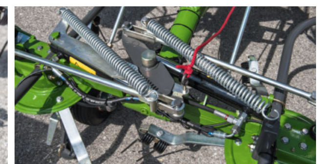
Die Synchronaushebung sorgt beim Arbeiten in Hanglagen für Sicherheit beim Klappvorgang.
