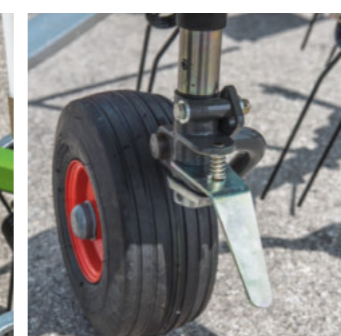
Die serienmäßige Randstreueinrichtung wird schnell und einfach über einen Hebel an den Kreiselrädern verstellt.
