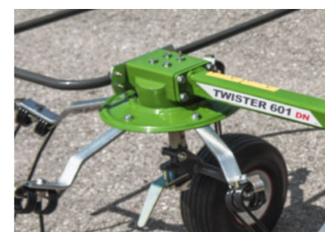
Die geschlossenen Kreiselköpfe sind zuverlässig vor Schmutz- und Staubeintrag geschützt und überzeugen so mit einer langen Lebensdauer.
