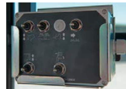
Dank der elektromagnetischen Komfortbedienung haben Sie alle Funktionen vom Traktorsitz aus im Griff.
