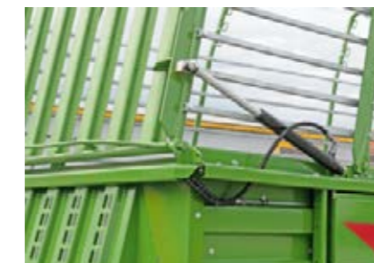
Optional kann der Dürrfutteraufbau auch komfortabel hydraulisch geklappt werden.
