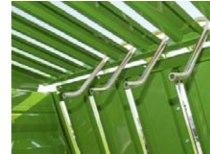
Mit der Zwei-Stufen-Ladeautomatik erfolgt die leichte Pressung über einen Tastrechen während die Mittlere über die Ladeklappe erfolgt.
