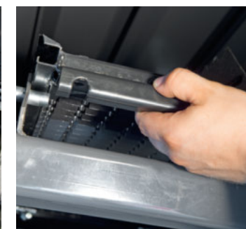
Ausbau der Siebe
