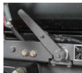
Verhindert Schäden an angehängten Geräten und Fehlbedienung: die Fixierung der Unterlenker über den Absperrhahn.
