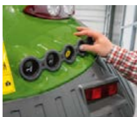
Der Heckkraftheber, die Zapfwelle und ein Steuerventil können an beiden hinteren Kotflügeln bedient werden.
