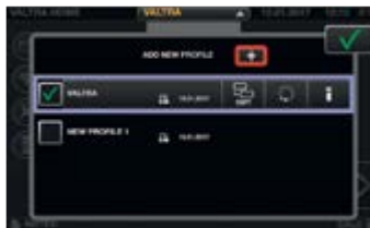
Profile für Fahrer und Arbeitsgeräte mit einfacher Änderung über jedes beliebige Bildschirmmenü. Speichern aller Einstellungsänderungen im ausgewählten Profil.
