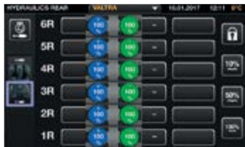
Steuerung der Hydraulik über jedes Bedienelement, auch die Hydraulikventile (vorn und hinten), Hubwerke (Front und Heck) oder der Frontlader.
