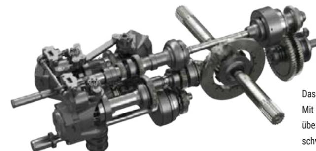
Das Fendt Variogetriebe ist ein hydrostatisch-mechanisch leistungsverzweigter Fahrtrieb. Mit zunehmender Geschwindigkeit nimmt der Anteil der mechanisch übertragenen Leistung über den Planetensatz zu. Für den ausgezeichneten Wirkungsgrad sorgen die um 45 Grad schwenkbaren Hydrostaten und der hohe Betriebsdruck von maximal 550 bar.
