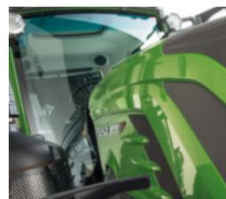
□ Bei Fendt werden die Scheiben der Kabinen eingeklebt, nicht eingeklemmt. Dies verbessert nicht nur das Sichtfeld des Fahrers. Vor allem werden Quietschgeräusche und Undichtigkeiten vermieden. Zusätzlich ist sie beheizbar.
