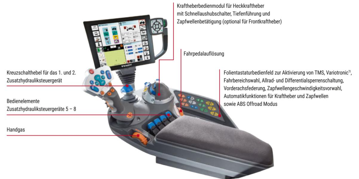
Kreuzschalthebel für das 1. und 2. Zusatzhydrauliksteuergerät
