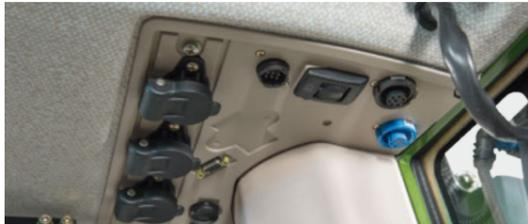
□ Zahlreiche Steckdosen stehen in der Kabine zur Verfügung, z. B. mehrere 12-Volt-Steckdosen, ISOBUS Steckdose, Signalsteckdose.
