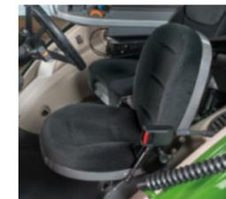
□ Der Komfort-Beifahrer-Sitz mit Rückenlehne und Sicherheitsgurt bietet auch Mitfahrern Sicherheit und Komfort für lange Arbeitstage.
