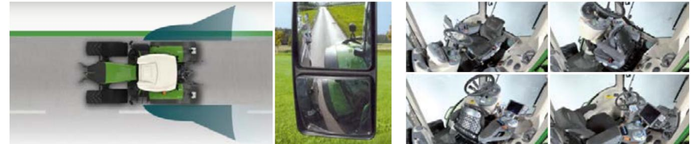
Um das Einsatzspektrum nochmals zu erweitern, bietet Fendt ab Werk eine vollwertige Rückfahreinrichtung an. In nur wenigen Schritten lässt sich der Fahrersitz samt Lenkrad, Multifunktionsarmlehne und aller Bedienelemente um 180 Grad drehen.
