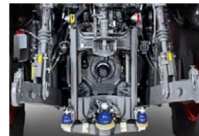
Die Unterlenker des Heckkrafthebers können in Parkposition hochgeklappt werden, so dass mehr Freiraum zur Deichsel entsteht.
