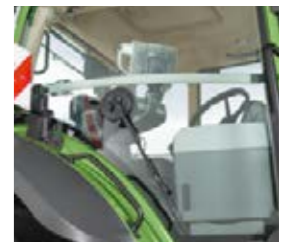
Der 220°-Seitenscheibenwischer gewährleistet auch bei widrigen Bedingungen eine optimale Sicht zur rechten Seite.
