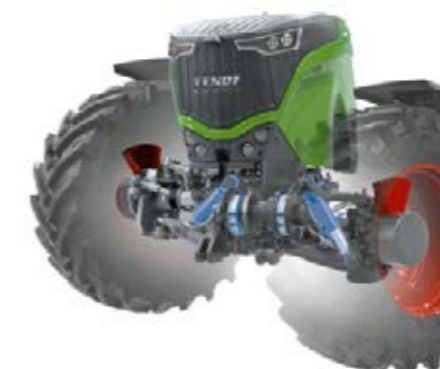
Vorderachse mit niveaugeregelter Einzelradfederung und Einzelradbremse.
