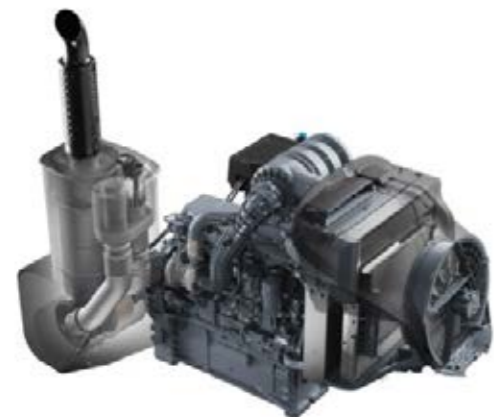
Der 12,4 l-MAN-Motor mit Common Rail erreicht einen hohen Einspritzdruck von 1.800 bar und damit einen hohen Wirkungsgrad.
