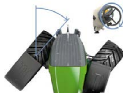
Mit VarioActive erreichen Sie schon mit einer Lenkradumdrehung den vollen Lenkeinschlag.
