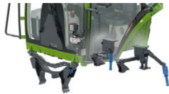
Die mechanische Kabinenfederung liegt vorne auf zwei Konuslagern und hinten auf zwei mechanischen Federelementen.
