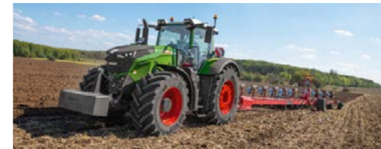
Dank Traktor-Management-System TMS und automatischer Grenzlastregelung 2.0 stimmt der Traktor die Motordrehzahl optimal auf die Fahrgeschwindigkeit ab.
