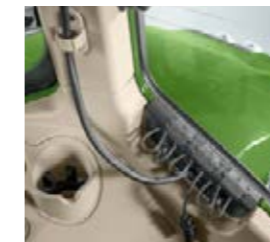
Die integrierte Kabeldurchführung ermöglicht eine saubere Kabeldurchführung bei geschlossener Heckscheibe mit Schmutz-, Wasser- und Geräuschschutz. Kein Kabelsalat: An den Kabelführungen an der C-Säule sind alle Kabel ordentlich befestigt.
