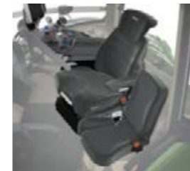
Der Super-Komfortsitze Evolution dynamic ist luftgefedert und verfügt über eine aktive Klimatisierung sowie eine Rückenlehnenverlängerung.
