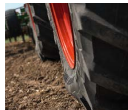
Die perfekt integrierte Reifendruckregelanlage VarioGrip regelt Reifenluftdrücke zwischen 0,6 bis 2,5 bar innerhalb weniger Minuten. Kraftstoffersparnis, Bodenschonung und Traktionssteigerung sind die Ergebnisse des optimalen Reifenluftdrucks.
