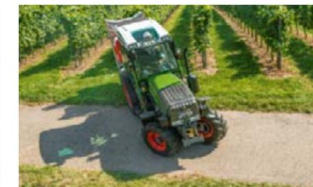
Die schlanke Wespentaille erlaubt einen hohen Lenkeinschlag bis 58° und in Kombination mit der VarioActive Lenkung eine überragende Wendigkeit.
