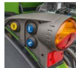
■ An den hinteren Kotflügeln befindet sich die externe Bedienung für Hydraulik und Zapfwelle.
