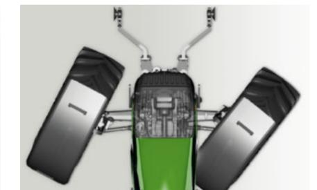
Mit der VarioActive Funktion erreichen Sie mit nur einer Lenkradumdrehung den maximalen Lenkeinschlag.
