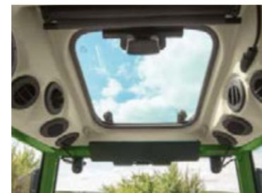
Das serienmäßige Dachfenster sorgt für beste Sicht bei allen Überkopfarbeiten. Zur Belüftung der Kabine kann das Fenster nach oben geöffnet werden. Vor intensiver Sonneneinstrahlung schützt das Sonnenrollo.
