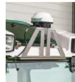
Positionsbezogene GPS-Lenksysteme erreichen im Fendt 200 V/F/P Vario eine Genauigkeit von bis zu 2 cm.
