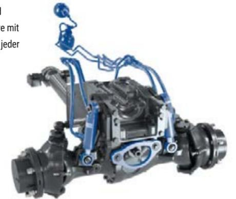
Bodenschonung ist die Kombination vieler Maßnahmen: Pendelkraftheber mit weit und tief vorn liegendem Zugpunkt, Allrad- und Differentialsperrenautomatik, Niveauregulierung und Wankabstützung der Vorderachse. Optimale Traktion unter allen Bedingungen.
