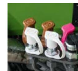
□ Die hydraulische Querverbindung vermeidet lose Schläuche die über der Haube liegen.
