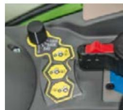
■ Die gewünschte Zapfwellengeschwindigkeit wählen Sie bequem über das Drehrad.
