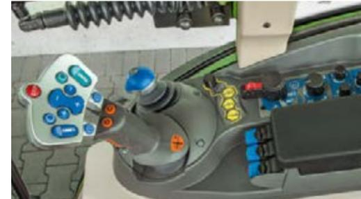
In der Standardausführung bedienen Sie den Fendt 200 V/F/P Vario per Vario-Joystick, der auch über eine Motordrehzahlspeichertaste und die Tempomatspeichertaste verfügt.
