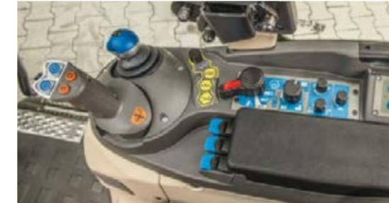
Mit der Stop&Go Funktion am Wendeschalthebel verzögert der Fendt V/F/P Vario bis zum Stillstand und beschleunigt in die Richtung, in die der Taster betätigt war. Absolut ruckfrei und bodenschonend.
