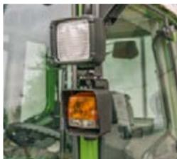
□ Integrierte Arbeitsscheinwerfer in der A-Säule sorgen für zusätzliche Ausleuchtung der Umgebung.
