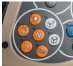
Die VarioActive Überlagerungslenkung und die Spurführung aktivieren Sie bequem an der Lenkradkonsole.
