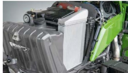
Die Kühlanlage in U-Form verfügt über große Ansaugflächen mit optimaler Luftzufuhr. Daraus resultiert eine geringe Kühlerverschmutzung auch bei extremen Einsatzbedingungen.
