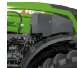
□ Sauber integriert ist die Zweikreis-Druckluftbremsanlage.
