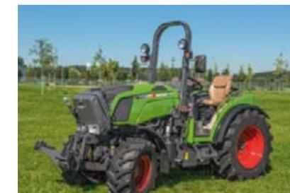
Für den Einsatz in Gewächshäusern oder unter besonders engen Bedingungen bietet Fendt Varianten ohne Dach und mit Überrollbügel an.
