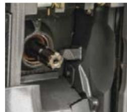
■ Die Zapfwellenstummel sind dank angeschrägtem und angeharstem Profil besonders leicht zu koppeln.
