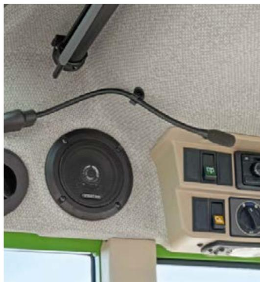
□ Mit der Freisprecheinrichtung führen Sie klare und deutliche Telefonate über die Bluetooth-Schnittstelle.
