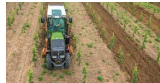
Der kleinste Spurbereichradius beträgt nur 3,2 m je nach Bereifung. Das merken Sie sofort am Reihenende wenn Sie ohne Richtungswechsel in die übernächste Zeile wechseln können.
