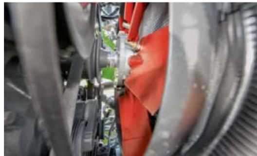
Umkehrlüfter mit verstellbaren Lüfterblättern bei Bedingungen mit viel Laubanfall: Vorteil: saubere Kühlgitter durch Freiblasen ohne Absteigen und damit mehr Leistungsfähigkeit und Effizienz.
