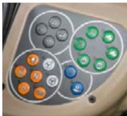
Im Armaturenbrett rechts bedienen Sie schnell und einfach per Klick die Vielfachanzeige, die Komfortschaltung für Allrad, Differentialsperre und Vorderachsfederung sowie das Traktor-Management-System TMS.
