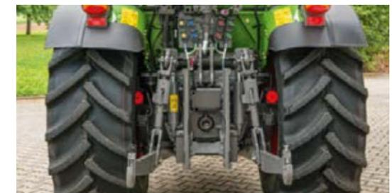
In der P-Variante steht Ihnen ein vollwertiger Kat2 Kraftheber zur Verfügung. Für alle Varianten gilt: alle Anschlüsse sind übersichtlich angeordnet und gut erreichbar.
