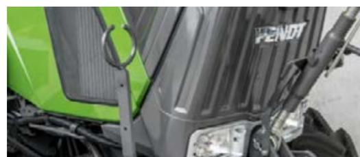
□ Die Hydraulikschläuche sind dank Halter an beiden Seiten immer sauber und aufgeräumt.
