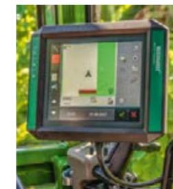
Das Spurführungsterminal ist optimal integriert und gut ablesbar.
