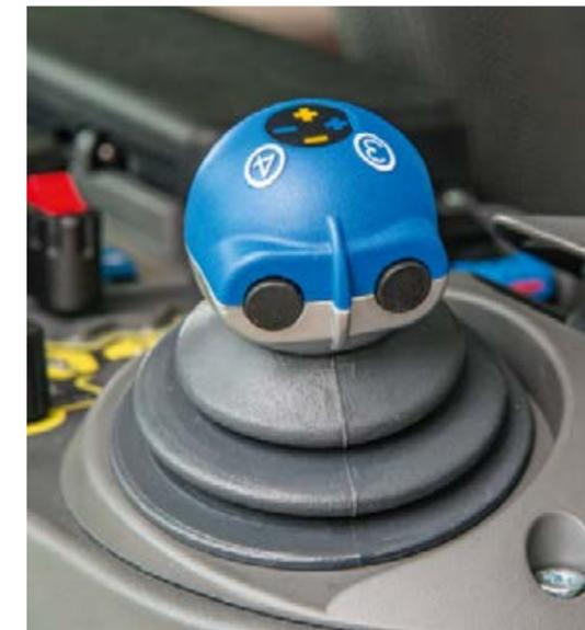
■ Den dritten und vierten Steuerkreis betätigen Sie bequem vom elektrischen Kreuzschalthebel als Taster oder Schalter.
