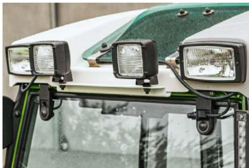
□ Bei Ausführung mit Zusatzscheinwerfer können vorne zusätzlich zwei Arbeitsscheinwerfer angebaut werden.
