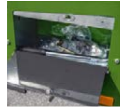
Für schnelle Wartungsarbeiten ist eine Werkzeugkiste in der Deichsel des Fendt Slicer 3575 T integriert.
