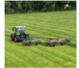
Der gezogene Zweikreisel-Seitenschwader Fendt Former 1502 bietet eine Arbeitsbreite von bis zu 6,3 m bei Einswadablage.
