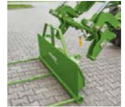
Die automatische Werkzeugverriegelung bietet enormen Komfort und Sicherheit beim Werkzeugwechsel.
