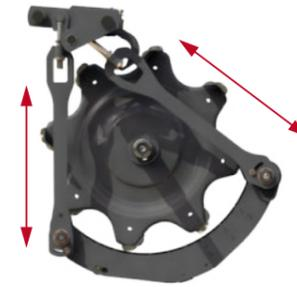
Der Abscheidekorb ist unter den Multi Crop Separator (MCS) geschwenkt. Mit dieser Einstellung wird die Abscheideleistung bei langem Stroh und feuchten Bedingungen verbessert, so dass auch unter schwierigen Bedingungen hohe Durchsatzleistungen möglich sind.
