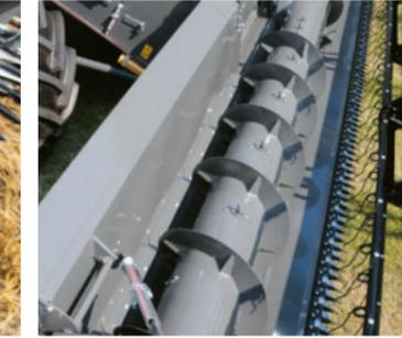
Der PowerFeed-Roller führt das Erntegut sehr gleichmäßig vom Schneidwerk in den Schrägförderer.
