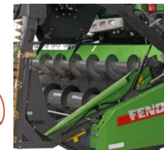
Die optionale Rapsschnecke erhöht den Gutfluss zum Schrägförderer in hohen Beständen und ermöglicht eine erhöhte Durchsatzleistung.
