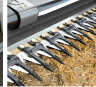
Am FreeFlow-Schneidwerk erhöhen über die gesamte Breite angeordnete Einzugsfinger den Durchsatz der Einzugsschnecke und gewährleisten eine aktive und schnelle Zufuhr in den Schrägförderer.
