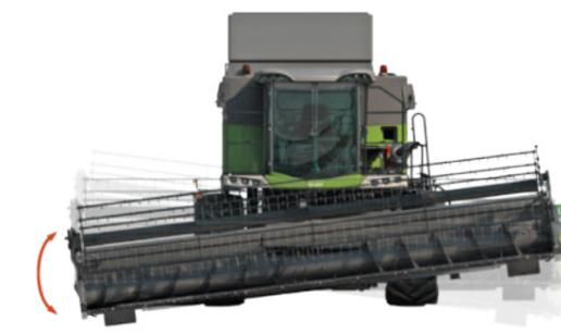
Die serienmäßige AutoLevel-Schneidwerksregelung sorgt für eine konstante Schnitthöhe über die gesamte Breite.
