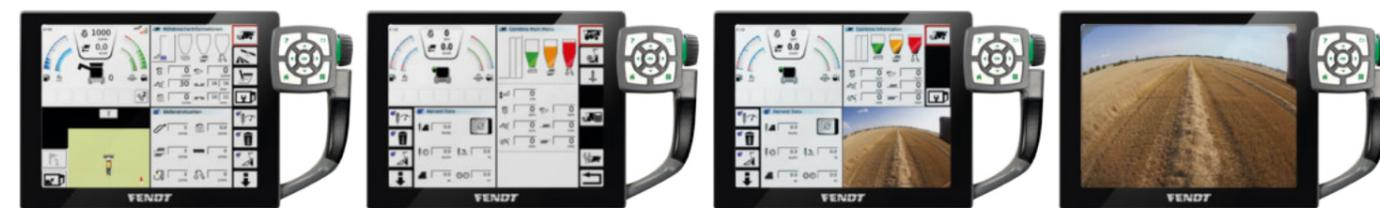
Die Hauptinformationsseite, oben links, zeigt die Motordrehzahl und Fahrgeschwindigkeit an. Daneben befinden sich die Anzeigen für Kraftstoff, AdBlue, Öl und Motortemperatur. Die Grafik zeigt den aktuellen Status der Korntankentleerung und der Entleerungsschnecke des Mähdreschers.
