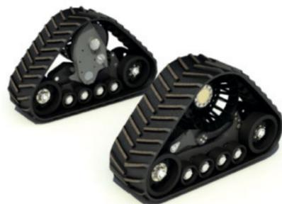
Die integrierten Endantriebe sind speziell für die hohen Lasten entwickelt. 4 Mittellaufäder sorgen für eine riesige Auflagefläche mit hoher Tragfähigkeit. Die progressive, integrierte Blockfederung ist einfach aber effektiv und bietet hohen Fahrkomfort.
