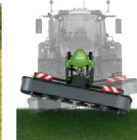
Bewegungsfreiheit wird hier groß geschrieben – mit einem Querpengelwinkel von +/-13° sowie einer vertikalen Bewegungsfreiheit von 650 mm ist das Slicer FQ Frontmäherwerk ein echtes Bewegungstalent.
