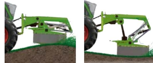
Am Vorgewende profitieren Sie von einer sehr hohen Bodenfreiheit und beschädigen keine Schwade.
