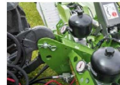
Behalten Sie mit dem Manometer stets den perfekten Auflagedruck des TurboLift-Systems im Blick und passen Sie ihn von der Kabine aus an.
