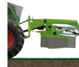
Der große Pendelweg von 20° sorgt auch bei Unebenheiten und am Hang für eine hervorragende Boden Anpassung.
