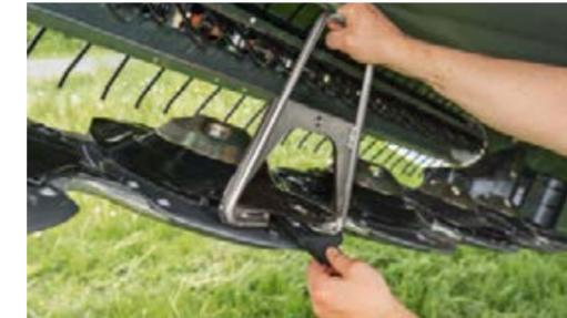
Mit den leicht austauschbaren DriveGuard-Scheiben ist der Kompaktwinkelantrieb perfekt geschützt.
