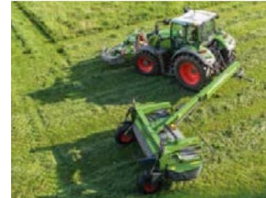
Der Mähbalken des Fendt Slicer TKC und TRC wird an den äußersten Punkten des stabilen Tragrahmens aufgenommen und garantiert so eine perfekte Boden Anpassung.
