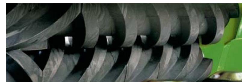
Die Rollenaufbereiter RC sorgen für eine schonende Aufbereitung ohne Blattverluste. Bei Abnutzung oder Beschädigung können die Gummielemente einzeln getauscht werden.
