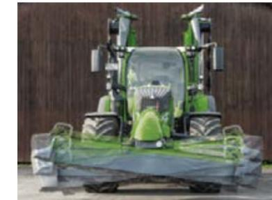
Die Fendt Slicer 310 FPK sind dank speziellem Pendelbock besonders nahe am Traktor und somit äußerst wendig.
