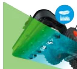
Die hydropneumatische Entlastung mittels TurboLift System ist beim Slicer FQ Standard. Die stufenlose Einstellung können Sie komplett werkzeuglos vornehmen. So ist der Auflagedruck immer perfekt an die vorherrschenden Bedingungen angepasst.
