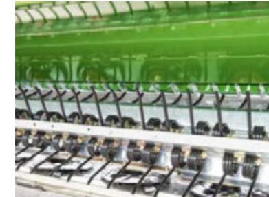
Alle Aufbereiter werden direkt über eine Welle im Haupteinganggetriebe oder über eine Gelenkwelle angetrieben.
