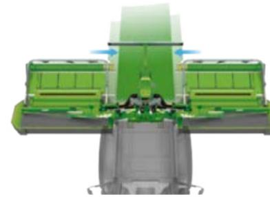
Der einzigartige, patentierte Anfahrtschutz SafetySwing lässt die Mähkombination im Falle eines Falles bis zu 1,5 m nach hinten und oben ausschwenken.
