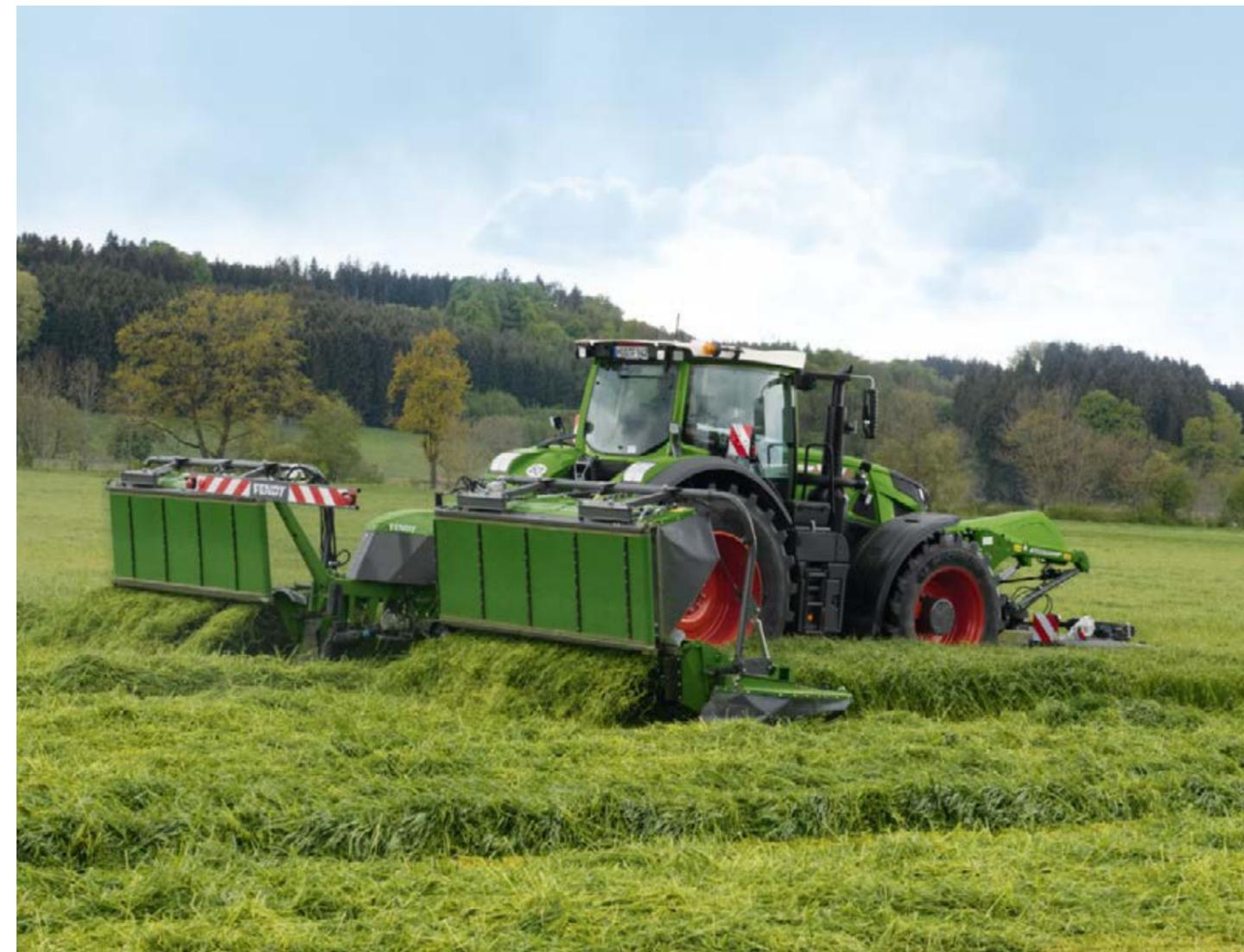
Per Tastendruck klappen Sie die Bänder nach oben und legen das Erntegut auf der gesamten Breite ab.
