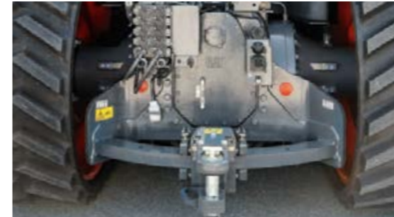
Das hydraulisch um 28 Grad je Seite mitlenkende Zugpendel hat die Anbaugeräte perfekt im Griff.
