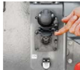
■ Für externe Verbraucher steht ein 12 V Anschluss im Heck zur Verfügung. Der ISOBUS-Anschluss schafft eine Verbindung zu den Anbaugeräten.
