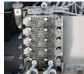
□ Im Heck finden sich sechs Hydraulikventile, ein Leckölanschluss und PowerBeyond.
