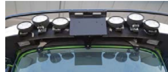
■ Halogen-Arbeitscheinwerfer leuchten die Umgebung perfekt aus. Auf Wunsch gibt es LED-Scheinwerfer.
