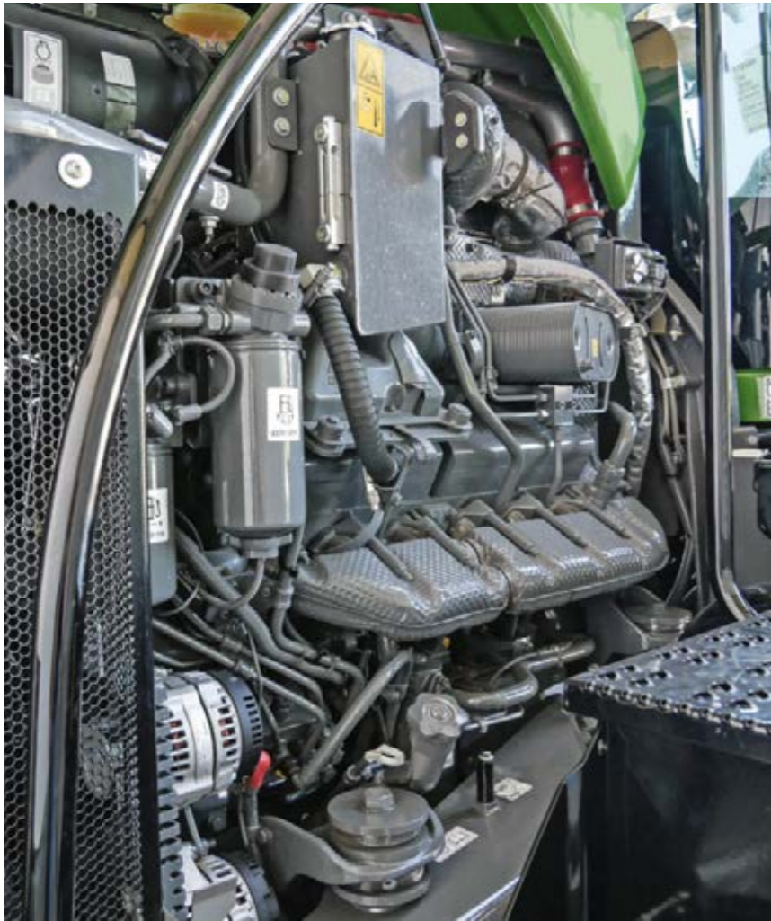
■ Der 12-Zylinder AGCO Power Motor besticht durch seine Laufruhe und gute Wartungszugänglichkeit.
