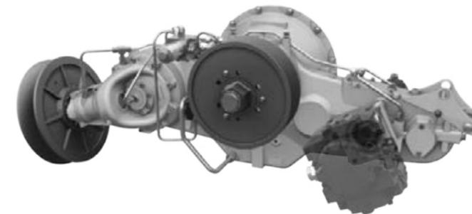
Hocheffiziente Kraftübertragung ist durch das neue DriveCenter möglich. Die Hauptkomponenten der Maschine wie Helix-Prozessor, Reinigung, Schneidwerk und Hydraulikpumpen werden durch die direkte Verbindung zum Motor optimal angetrieben.
