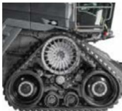
Für geringsten Bodendruck sorgt das Raupenlaufwerk TrakRide.
