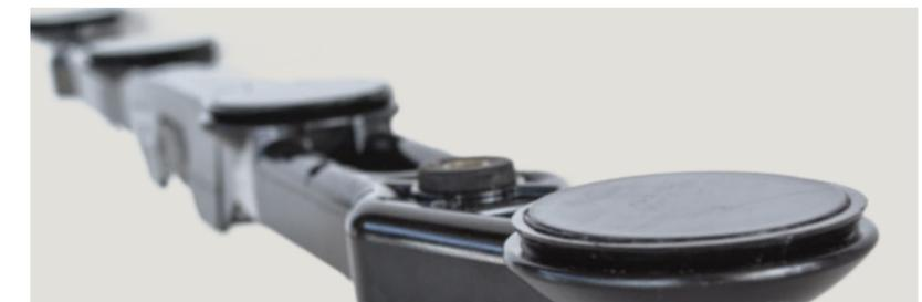
Verlustsensoren am Ende des Siebkastens helfen dem Fahrer bei der optimalen Maschineneinstellung, indem sie über Druck und Akustik herunterfallendes Erntegut erfassen.
