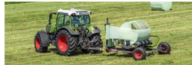
Der Fendt Rollector wickelt Ballen mit einem Durchmesser von 0,90 bis 1,30 m.
