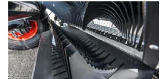
Im Topmodell 130 F Xtra steht Ihnen eine hydraulische Messergruppenschaltung von 0, 12, 13 und 25 Messern zur Verfügung.
