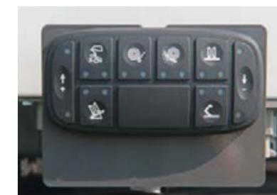
Bedienen Sie die Press-Wickel-Kombination ganz einfach mit dem hinteren Bedienpult an der Maschine zur manuellen Bedienung.
