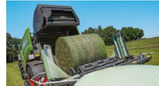
Der sanfte Antrieb des Wickelrings über hydraulisch angetriebene Gummierollen erreicht schnell die richtige Geschwindigkeit für einen gleichmäßigen Wickelvorgang.
