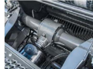
Der Kammerantrieb ist aufgeteilt und erfolgt über zwei Ketten.
