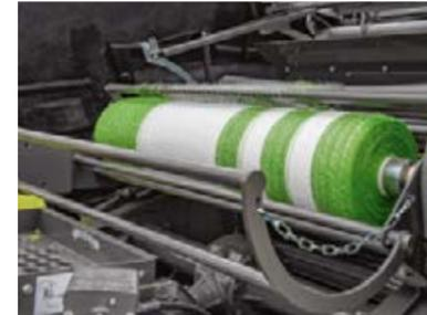
Die Netzbindung VarioNet funktioniert mit allen Standardnetzbreiten von 1,18 bis 1,35 m.
