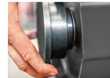
Die 50 mm messenden Lager an den Walzen sind für höchste Belastungen ausgelegt.
