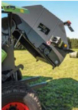
Ein Dorn an der Heckklappe sorgt dafür, dass sie auch beim Einsatz in Hanglagen zuverlässig geschlossen wird.
