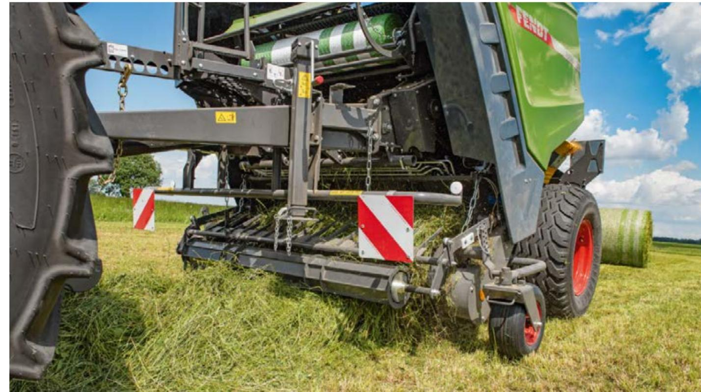
Den Rollniederhalter stellen Sie bequem über zwei Ketten an der Seite ein und regeln damit den Gutfluss zum Rotor optimal.
