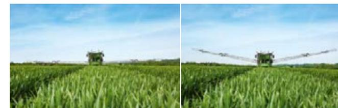
Einseitige Gestängeanwinkelung zur optimalen Applikationshöhe in stark kuppertem Gelände.
