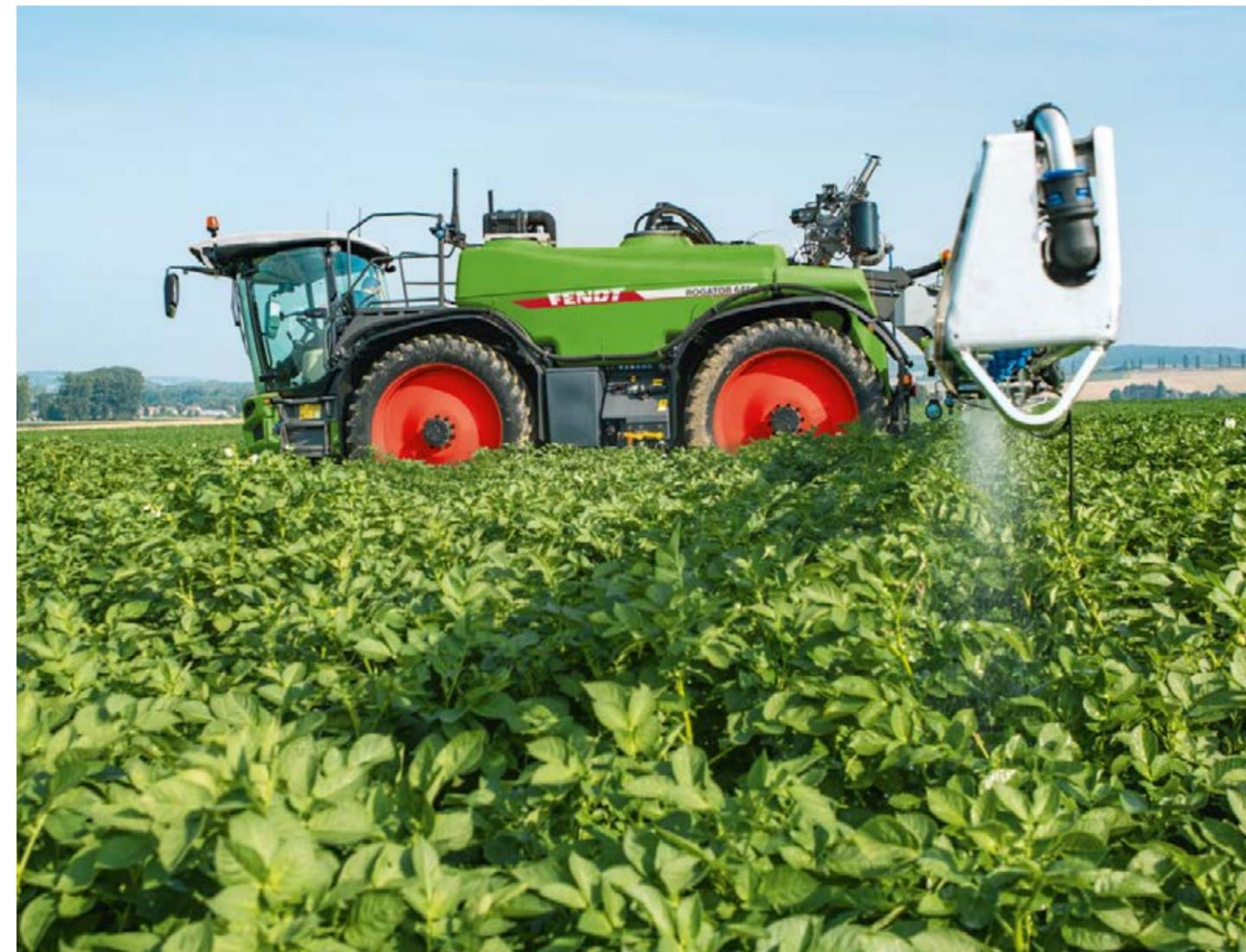
Durch die maximale Pumpenleistung von 785 l/min wird auch die Flüssigdünger-Applikation zur Nebensache. Der hydraulische Antrieb der Kreiselpumpe ruft über das CDS nur soviel Hydraulikleistung ab, wie tatsächlich benötigt wird. Der Fendt Rogator fährt immer mit der geringstmöglichen Drehzahl im effizienten Bereich.
