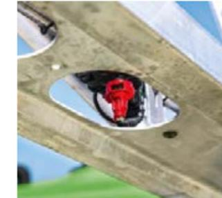
Ausreichend Freiraum für den Spritzfächer: auch beim Einsatz von Doppelflachstrahldüsen oder Düsen mit einem Abstrahlwinkel nach hinten oder vorn trifft jeder Tropfen die Zielfläche.
