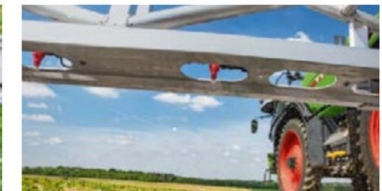
Durch das Gestängeprofil sind die Düsen vorne und hinten komplett geschützt.
