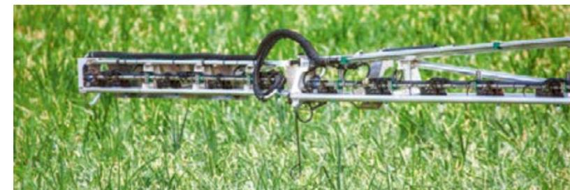
Die Fendt Rogator Anfahrtsicherung kann bis zu 90° wegdrehen. Die Rückschwenkbewegungen sind gedämpft, sodass keine zusätzlichen Impulse auf das Gestänge einwirken.
