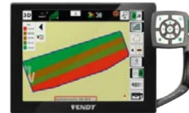
VariableRateControl: Flexible Ausbringungsmengen in Abhängigkeit von Applikationskarten oder Online Sensoren wie einem N-Sensor.
