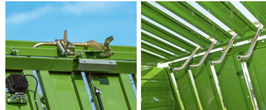
Mit der Zwei-Stufen-Ladeautomatik erfolgt die leichte Pressung über einen Tastrechen und während die mittlere über die Ladeklappe erfolgt.
