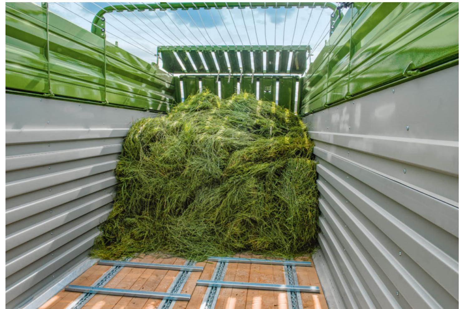
Mit der Zwei-Stufen-Ladeautomatik erfolgt die leichte Pressung über einen Tastrechen und während die mittlere über die Ladeklappe erfolgt.
