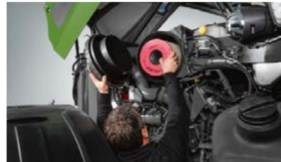
Der Verschmutzungsgrad der Luftfilter wird im Varioterminal angezeigt. Der Motorraum ist durch abnehmbare Seitenteile besonders gut zugänglich.
