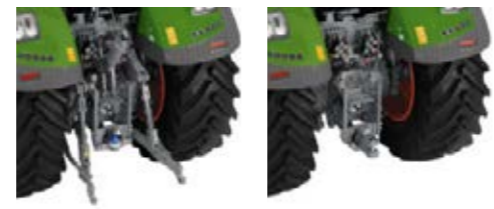
Heckkraftheber mit Schnellfanghaken und Seitenabstützung
