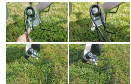
Durch eine einfache Verstellung der Zinken am äußeren Kreisel wird die Grenzstreu-Einrichtung aktiviert. Diese werden dazu in die innere Position gebracht und sorgen somit für einen saubereren Feldrand und eine perfekte Verteilung des Mähgutes.
