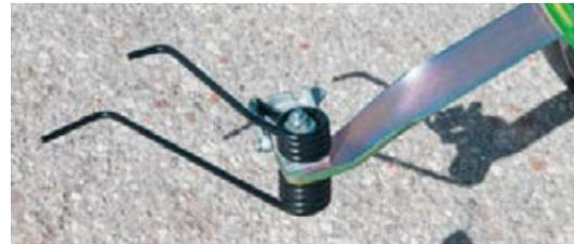
Die spezielle Zinkenbefestigung mit veränderbarem Anstellwinkel ermöglicht Ihnen die einfache Umstellung auf Grenzstreuen oder Nachtschwaden und schützt gleichzeitig vor Zinkenverlust.
