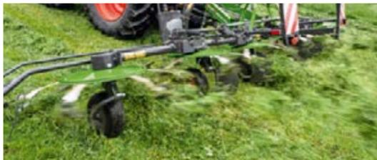
Das Anti-Wickel-System verhindert ein Aufwickeln des Ernteguts an den Radachsen.
