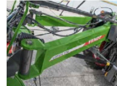
Für den Transport werden die Kreisel hydraulisch geklappt und mechanisch gesichert.
