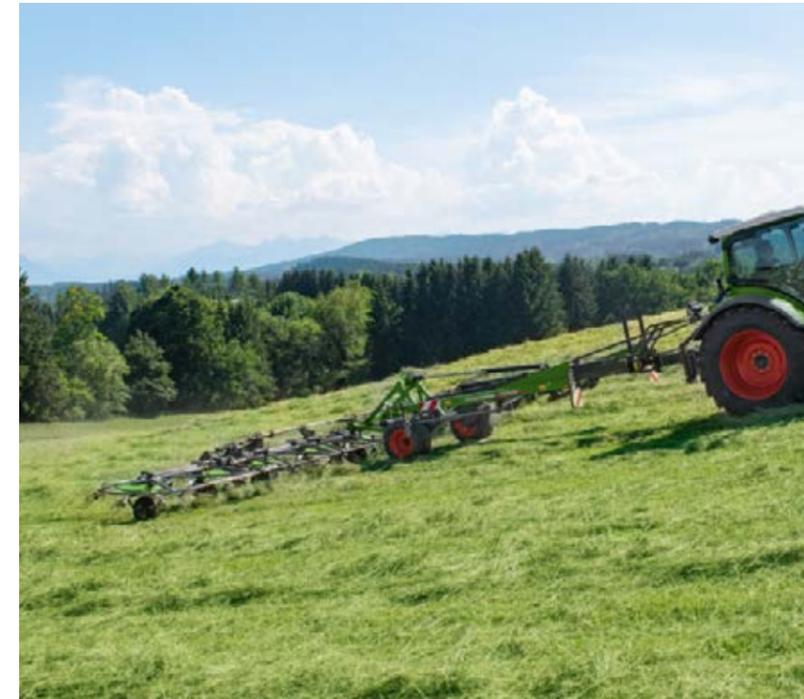
Über die Arbeitsbreite verteilt, befinden sich mehrere Drehgelenke zwischen den Kreiseln, die für eine individuelle Bodenangepassung der Kreisel sorgen. Das garantiert niedrigen Verschleiß und sauberes Futter.
