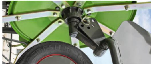
Die Streuwinkelposition können Sie einfach und unkompliziert über einen Bolzen ändern. Sie haben die Wahl zwischen fünf Positionen von 10 bis 17° – immer genau angepasst an Ihre Bedürfnisse.
