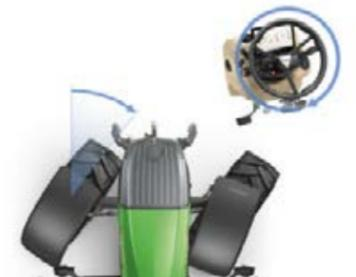
Am Vorgewende oder bei Frontladerarbeiten profitieren Sie von der FendtActive Lenkung\* weil Sie mit nur einer Lenkradumdrehung bereits den vollen Radeinschlag erreichen. Bis 8 km/h hat die Überlagerungslenkung keine Einschränkung, ab 8 bis 18 km/h reduziert sich die Überlagerungslenkung linear.
