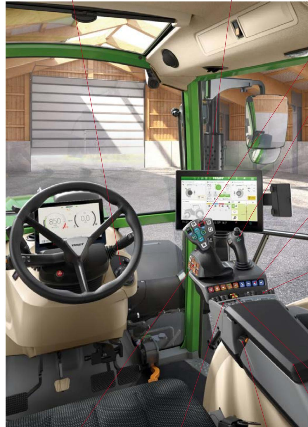
Der neue Multifunktions-Joystick enthält neben der vertrauten Kleeblatt-Bedienung zwei Bedienelemente für die proportionale Ventilsteuerung sowie vier frei belegbare, weiße Tastenfelder.
