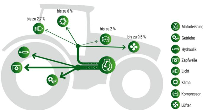
Der neue Visctronic Lüfter passt sich elektronisch geregelt besonders feinfühlig an den echten Kühlbedarf an. Das spart bis zu 1,4 % Kraftstoff und bringt einen leiseren Lauf im Vergleich zu einem konventionell geregelten Lüfter. Dazu kommen noch der reduzierte Wartungsaufwand und längere Einsatzintervalle, auch bei staubigen Bedingungen.
