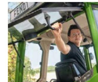
Ein besonderes Merkmal des Fendt 200 Vario ist der senkrechte Griff an der Heckscheibe, mit dem die Scheibe angenehm im Sitzen geöffnet und geschlossen werden kann.
