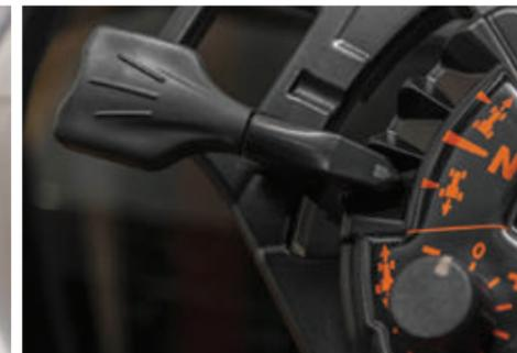
Das **serienmäßige mechanische Getriebe** ermöglicht einen einfachen Richtungswechsel, während die **optionale PowerShuttle-Funktion** den Wechsel der Fahrtrichtung ganz ohne Bedienung der Kupplung gestattet. Die Gänge lassen sich mit den seitlich angebrachten Hebeln besonders sanft wechseln.
