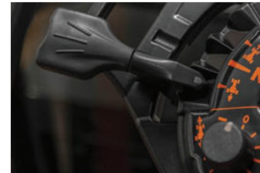
Der exklusive **PowerShuttle-Hebel** ermöglicht die bequeme und einfache Bedienung von drei Funktionen. Der Fahrer kann die Fahrrichtung wechseln (Vorwärts/Rückwärts) oder den Leerlauf anwählen und dabei die rechte Hand zur Bedienung von Heckhubwerk oder Hydraulikgeräten frei behalten.
