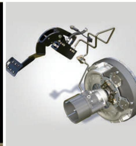
Die hydraulische Unterstützung und Pedale sorgen für besonders leichtgängige Gangwechsel, wie in einem modernen Pkw.
