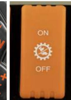
**SpeedMatching** erlaubt die automatische Auswahl der richtigen Lastschaltstufe. Bei Bedarf wird es einfach mit dem entsprechenden Schalter auf der rechten Konsole aktiviert.
