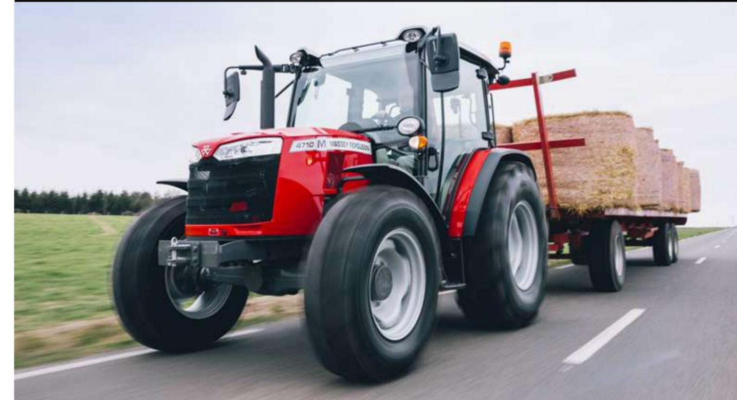
Mit dem preisgekrönten „All-in-One“-System von Massey Ferguson, das jetzt auch über einen einfach gehaltenen Rußkatalysator verfügt, erfüllen alle Traktormodelle der Baureihe MF 4700 M die strengen Abgasvorschriften der Stufe 5.
