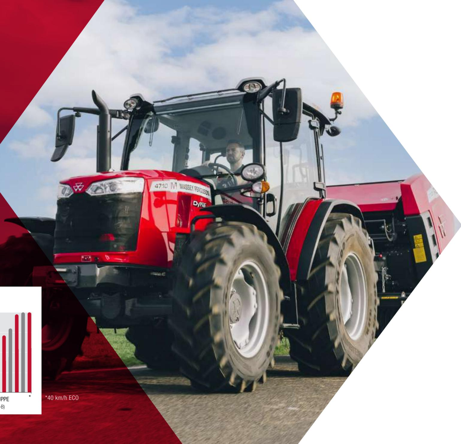
Das serienmäßige **ECO-Getriebe** erzielt Maximalgeschwindigkeiten bis 40 km/h bei 1.850 U/min und ist besonders leise und sparsam im Einsatz.
