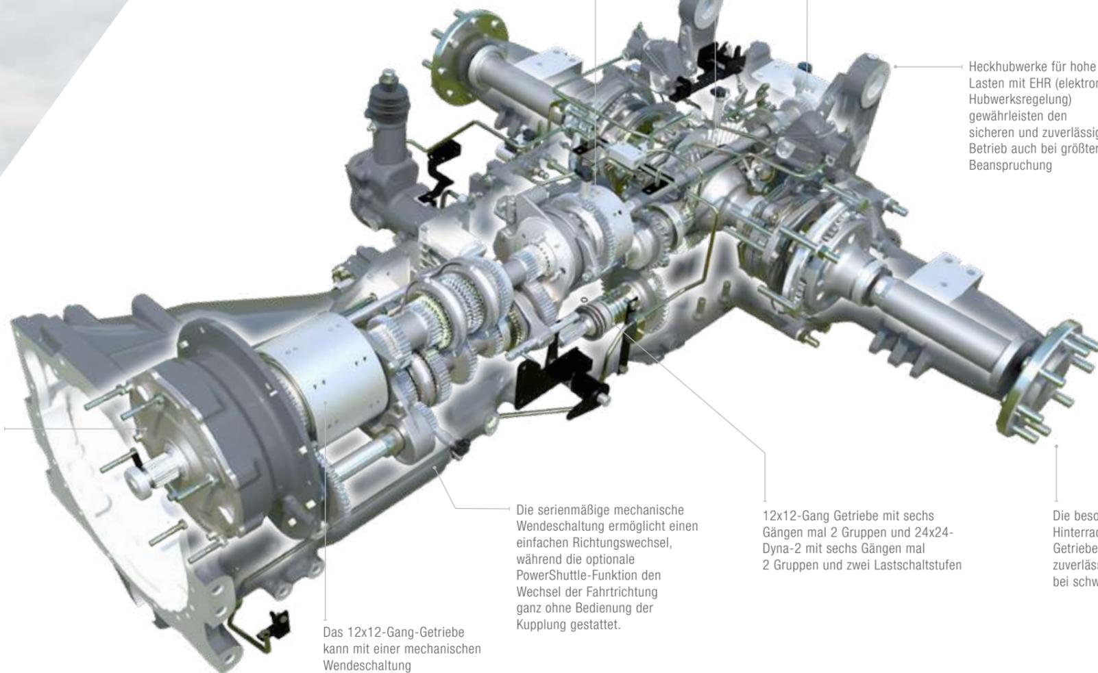
Das 12x12-Gang-Getriebe kann mit einer mechanischen Wendeschtaltung oder mit einem unter Last schaltbaren und einstellbaren PowerShuttle ausgestattet werden.
