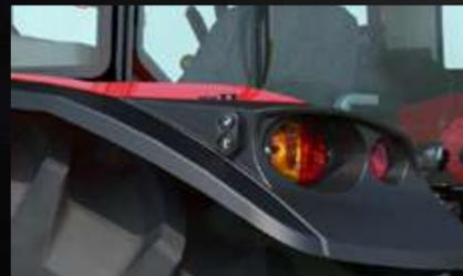
Externe elektrische Tasten am Kotflügel ermöglichen das einfache Anheben/Absenken des Heckhubwerks, wenn Heckanbaugeräte an- oder abmontiert werden (serienmäßig bei der Kabinen-Version).
