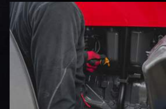
Das Design der Vorderachse und der schmalen Motorhaube erleichtert den Zugang zum Ölpeilstab und zum Ölfilter.
