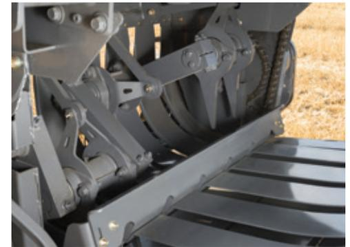
Die Rafferzinken gewährleisten eine gleichmäßige Zuführung in die Vorpresskammer.
