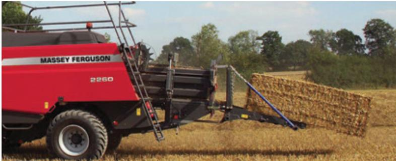
Die integrierte Ballenwaage ermittelt das Gewicht des Ballens beim Verlassen der Presskammer auf der Ballenrutsche.
