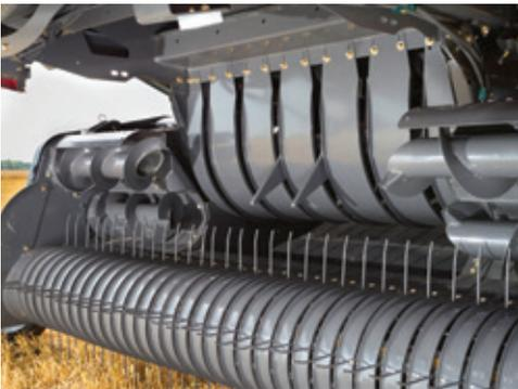
Vier Zentrierschnecken sorgen bei Ballenpressen mit „Raffer“ für eine schnelle Zuführung.
