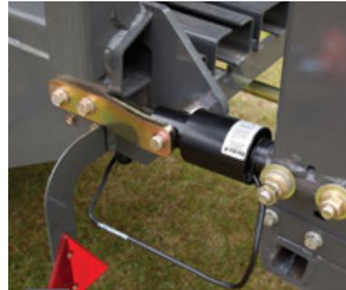
Hochgenaue Lastsensoren für die integrierte Ballenwaage.
