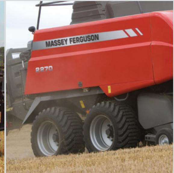
Ballenpresse MF 2270 mit Tandemachse
