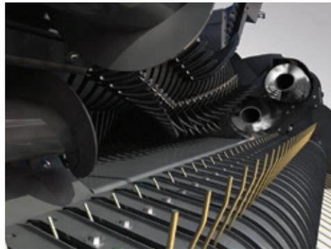
Die Ballenpressen mit Schneidwerk sind ebenfalls mit Zentrierschnecken ausgestattet, die eine gleichmäßige Erntegutzufuhr in den ProCut-Rotor gewährleisten.
