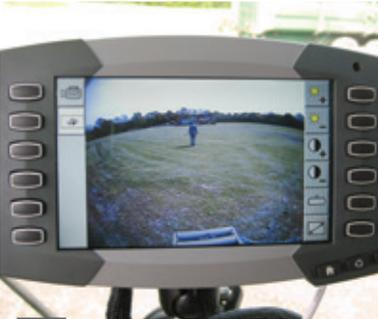
Durch bereits serienmäßig vorhandene Anschlüsse lässt sich problemlos eine Rückfahrkamera mit der Ballenpresse verbinden. Das Bedienterminal C1000 verfügt bereits serienmäßig über einen videotauglichen Farbbildschirm.
