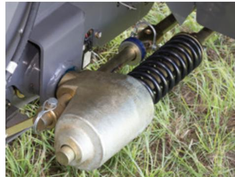
Führung der Pickup mittels Druckfeder für hohe Arbeitsgeschwindigkeit.
