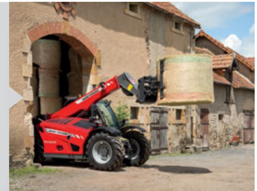
Zwei verschiedene Kabinenpositionen bieten höchste Flexibilität – so ist eine niedrige Position für Ladearbeiten in sehr niedrigen Gebäuden möglich. Perfekt für das Arbeiten bei begrenzten Platzverhältnissen. Durch das kompakte Design erreichen diese Modelle auch engste Bereiche, ohne dass Rundumsicht und Wendigkeit verloren gehen.
