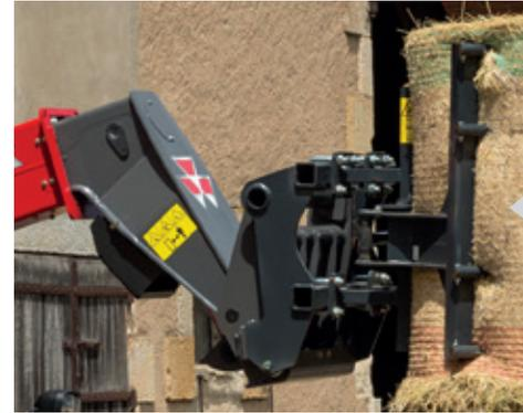
Am Auslegerkopf sind integrierte Schnellverbindungskupplungen mit Druckentlastung optimal positioniert, um das An- und Abkuppeln von Arbeitsgeräten schnell, effizient und einfach zu gestalten.
