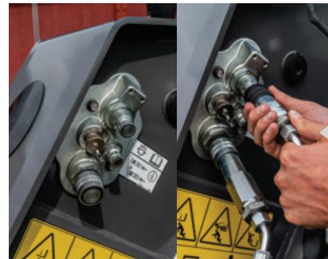
An- und Abkuppeln ist dank eines Anschlussblocks mit Druckentlastung denkbar einfach. Für anspruchsvollere Arbeitsgeräte wie Strohverteiler und Silageschaufeln können elektrische Leitungen gewählt und somit eine vierte und fünfte Funktionalität hinzugefügt werden.
