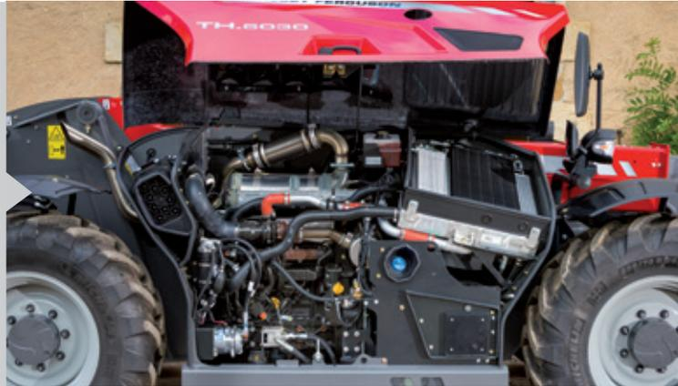
Der Luftfilter kann zur Überprüfung und Reinigung einfach entnommen werden. Falls erforderlich, ist jedoch optional ein automatischer Umkehrlüfter erhältlich. Drücken Sie einfach auf den Schalter oder aktivieren Sie die Automatik und der Lüfter ändert seine Drehrichtung, um Staub, Stroh und andere Materialien auszublasen, die sich in der Kühleereinheit verfangen haben.
