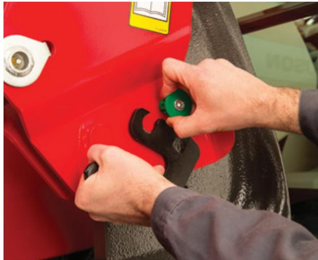
Arretierung lösen, dann Bolzen drehen und ziehen
