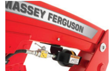
Die SoftDrive-Federung reduziert die Beanspruchung von Frontlader und Traktor und sorgt für höchsten Fahrerkomfort. Sie wird über einen Absperrhahn in der Nähe des Speichers manuell aktiviert.
