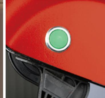
Jeder Sicherungsstift ist im Innern des Lagerbocks mit einer grünen Kennzeichnung versehen, sodass vom Fahrersitz aus klar zu sehen ist, ob ein Stift eingerastet und gesichert ist.
