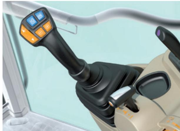
MF 5700 S-Kabinenoption Essential mit elektrischem Frontlader-Multifunktions-Joystick
