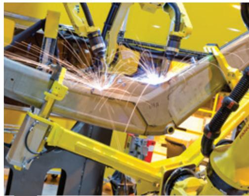
Roboter-geschweißter Rahmen garantiert Präzision und Stabilität
