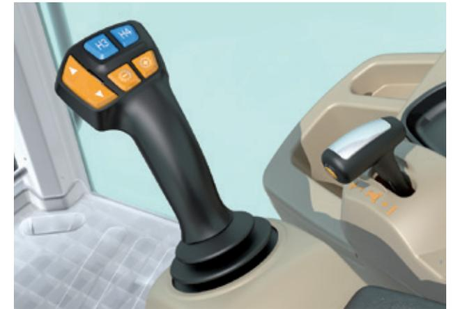
Kabinenoption Efficient mit elektrischem Multifunktions-Joystick und Armlehne
