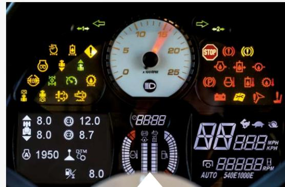
Das hochmoderne Armaturenbrett zeigt nicht nur die Drehzahl des Motors und der Zapfwelldrehzahl an, sondern auch Serviceintervalle, Kraftstoffverbrauch, zurückgelegte Strecke und bearbeitete Fläche, Öltemperatur und Betriebsstunden des Traktors sowie die gespeicherte Motordrehzahl und Wartungsinformationen.
