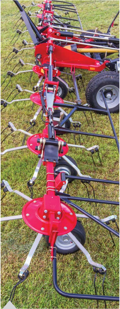
Seite 08 MF Heuwender mit Nachlaufeinrichtung (TR Hydro) und Transportfahrwerk (TRC)
