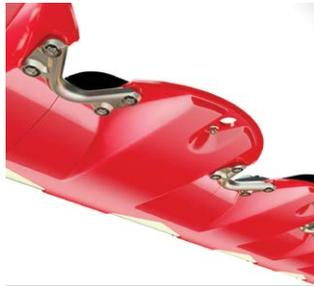
Stromlinienförmiger Messerbalken (Unterseite)
