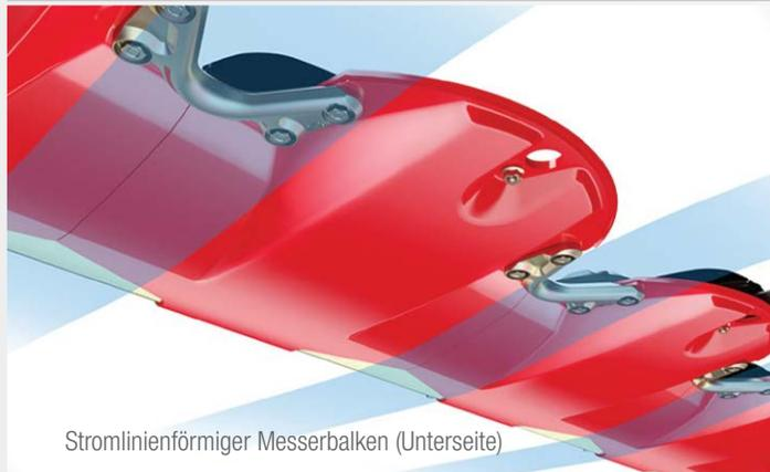
Stromlinienförmiger Messerbalken (Unterseite)
