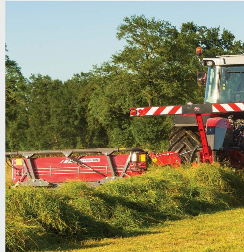
Die Mähkombinationen MF DM 8312 TL-KC bzw. RC und 9314 TL-KC sind auch mit **SafetySwing**-Anfahrtsicherung ausgestattet. Dadurch schwenken die Seitenmähwerke automatisch nach hinten und um die Schrägachse nach oben, sollte ein Hindernis getroffen werden.
